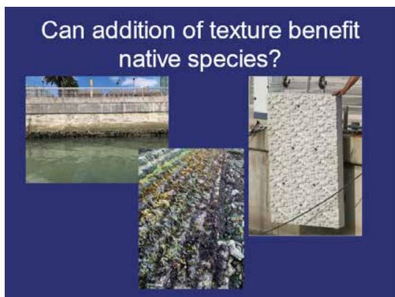
資料6 タイル質を使った垂直版をサンフランシスコ湾の垂直護岸に設置し
