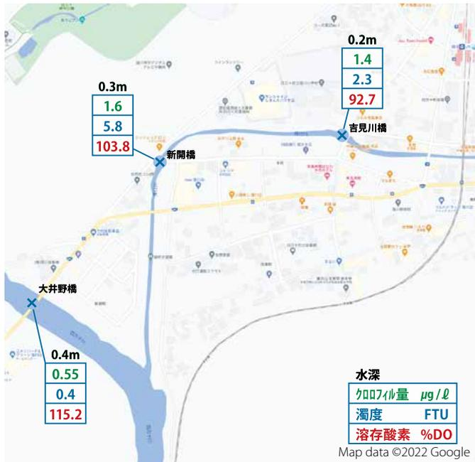
図3 2022年11月16日吉見川橋、新開橋と太井野橋のクロロフィル量、濁度と溶存酸素
