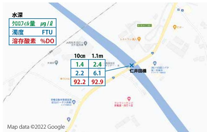
図2 2022年11月16日 仁井田橋のクロロフィル量、濁度と溶存酸素
