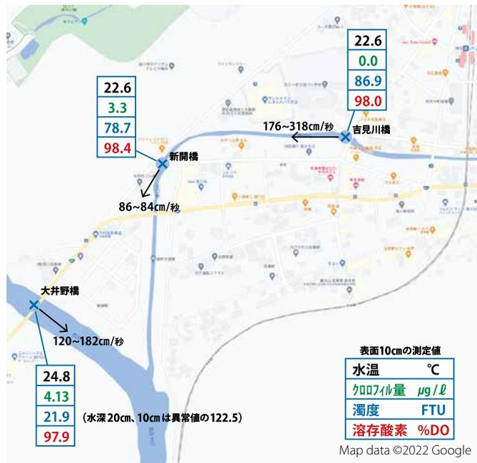
図2 吉見川橋、新開橋と太井野橋のクロロフィル量と流向流速 2022年7月3日
